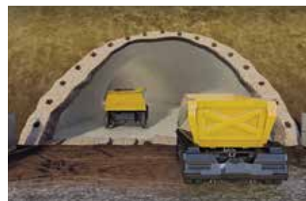
Abb. oben: Dragline-Shield-Technologie: Ein an Kabeln gezogenes „hyperShield“ gräbt sich durch den gelockerten Boden und zerkleinert den Abraum.
