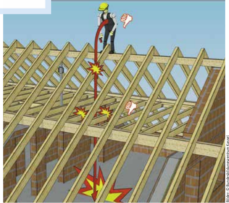
Abb. 2: Tiefer Absturz nach innen mit Anschlägen an Bauteilen
