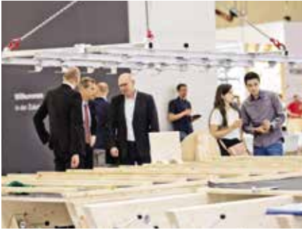
Die Traverse erleichtert den Transport, z. B. von Dach- oder Wandelementen vom Montagetisch.
