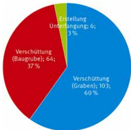
Abb. 2: Verteilung der Verschüttungsunfälle (BG BAU + Zeitungsmeldungen)
